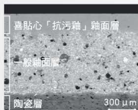
喜貼心「抗污釉」馬桶的顯微鏡片 *1 μm=0.001mm
