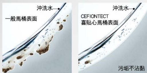
沖洗時馬桶表面的斷面放大示意圖
