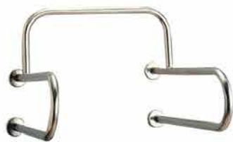
H-6141 1 1/4" \phi $10,200 小便斗扶手 * 600寬×500高×535深mm 註：附膨脹螺絲12支 材質：不銹鋼#304 (管徑 \phi 31.8mm)
