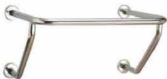
H-6111 1 1/4" \phi $9,200 面盆扶手 • 630寬×300高×503深mm 註：附膨脹螺絲12支 材質：不銹鋼#304 (管徑 \phi 31.8mm)
