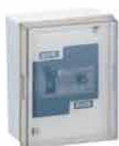
E-4502 $2,100 保安器 • 125×100×75mm 註：1.漏電30MA以上，開關自動跳脫 2.AC110V~220V，耐電流30A
