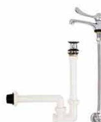
A-1146 1/2" $5,000 長柄式面盆配件 註：1. 下嵌式檯面適用 2. 出水口長130mm 3. 附無塞頭落水頭
