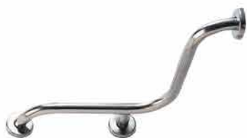
H-6153 1 1/4" \phi $5,200 L型扶手 * 500長×500寬mm 用途：浴缸角隅用 註：附膨脹螺絲9支 材質：不銹鋼#304 (管徑 \phi 31.8mm)
