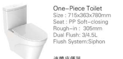
One-Piece Toilet Size : 715x363x780mm Seat : PP Soft-closing Rough-in : 305mm Dual Flush: 3/4.5L Flush System:Siphon 連體座便器 尺寸: 715x363x780mm 蓋板: PP緩降蓋板 坑距: 305mm 名義用水量: 3/4.5L 沖水系統:虹吸
